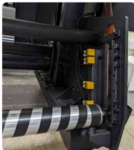
Независимые передний и задний вал, регулирующие натяжение, так называемый Dancing Bar
