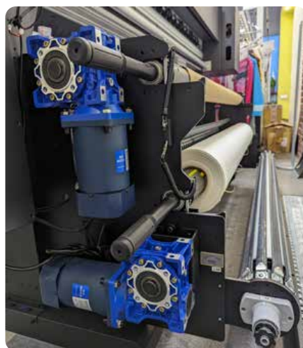
Два мощных мотора системы продвижения обеспечивают равномерную подачу
