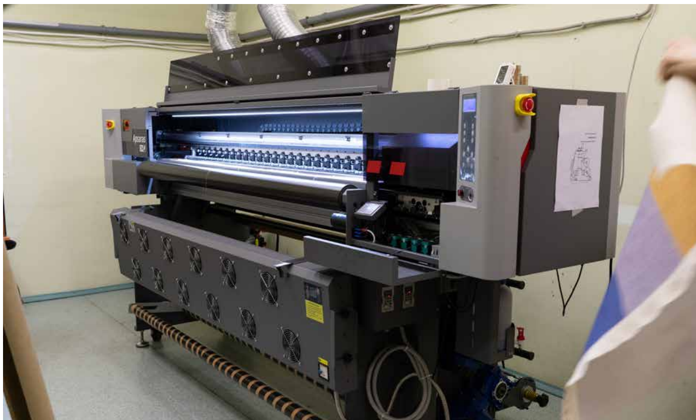
Пигментный принтер GongZheng Apsaras G4-P отвечает за прямую печать на натуральных тканях растительного происхождения
