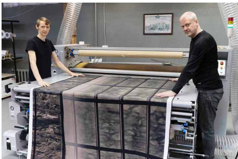
С помощью каландрового термопресса TitanJet принтерные отпечатки переносятся на ткань
