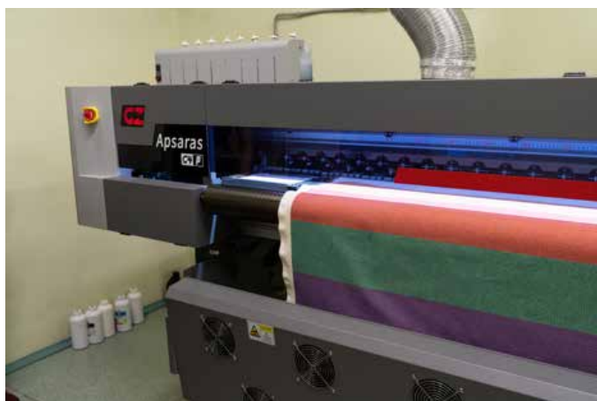
Пигментный принтер GongZheng Apsaras позволяет печатать напрямую на ткани, а каландр TitanJet служит для двухэтапного процесса печати
