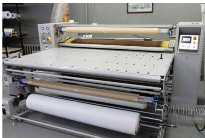
Пигментный принтер GongZheng Apsaras позволяет печатать напрямую на ткани, а каландр TitanJet служит для двухэтапного процесса печати
